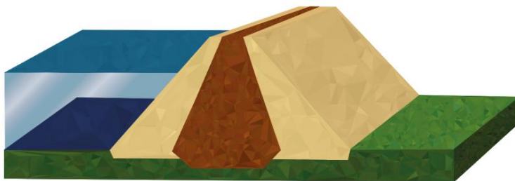
Figura 2 – Ilustração de Barragem de Terra Zonada.
