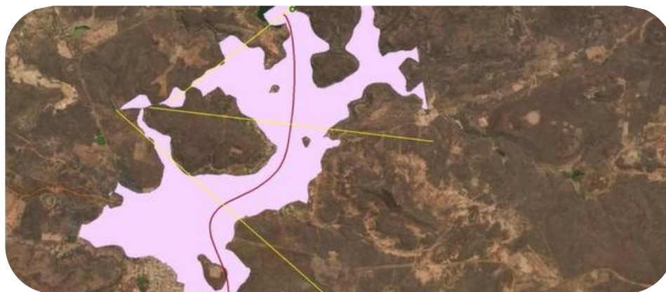
Figura 13 - Mancha de Inundação Simplificada Gerada para a Barragem de Bocaina, Localizada no Município de Bocaina, Piauí.
